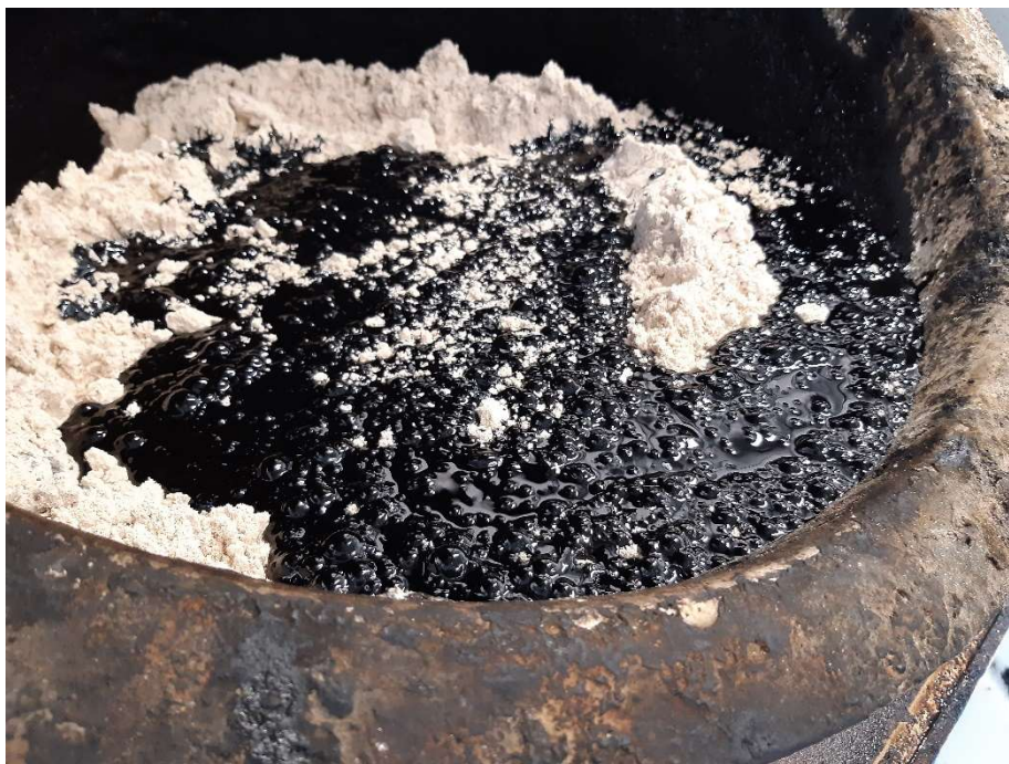
Abbildung 39: Bläschenbildung beim Mischen des Asphalts zufolge des feuchten Füllers
